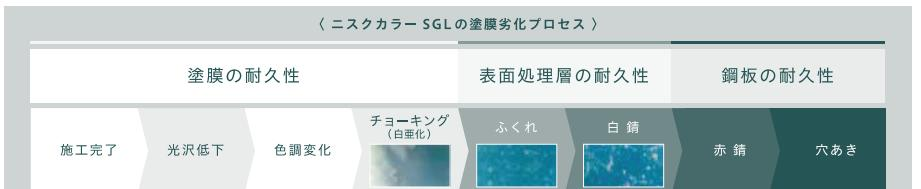
ニスクカラー SGL の塗膜面がチョーキングの末期状態でふくれが散見される状態が塗り替えの適性時期と見なせます。塗り替え塗料には、各塗料メーカーにより種塗料が市販されていますので、使用環境、耐用年数など勘案の上、施工工事業者とご相談ください。参考までに下記に塗り替え塗料の性能一覧表を示します。
